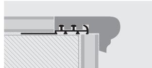
1. Scegliere PROSTYLE WOOD in funzione dello spessore del rivestimento.
